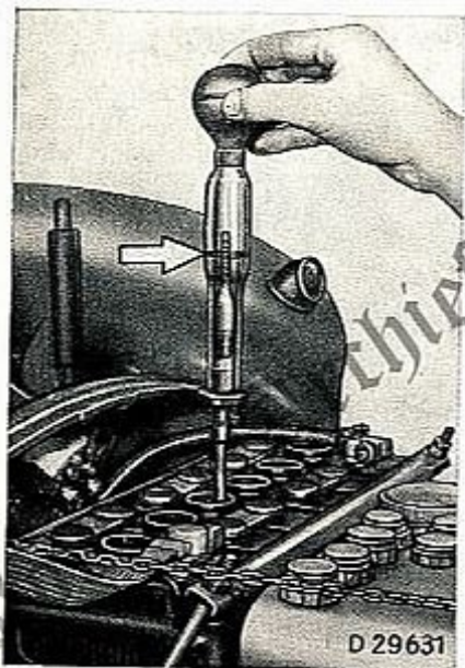
Bild 150. Prüfen der Säuredichte und des Ladezustandes der Batterie
