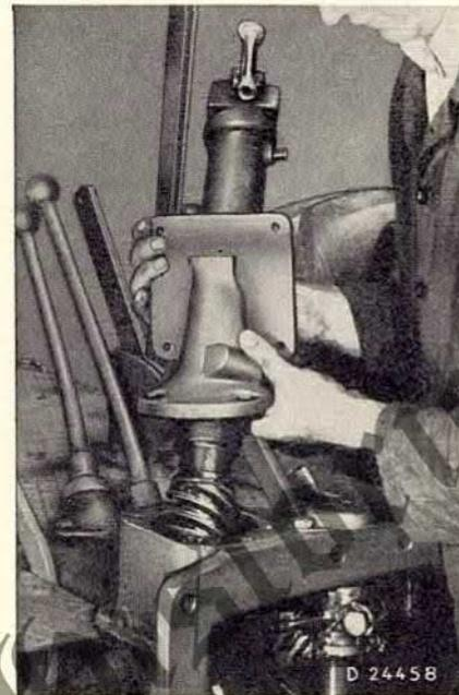
24. Bei Ackerluft-Bulldog D 7506 alten Lenkbock ausbauen. Steuersäule mit Lenkschnecke und Lenkrad in neuen Lenkbock 1.0704 d 145 einbauen. Längsspiel 0,1 mm einstellen.
